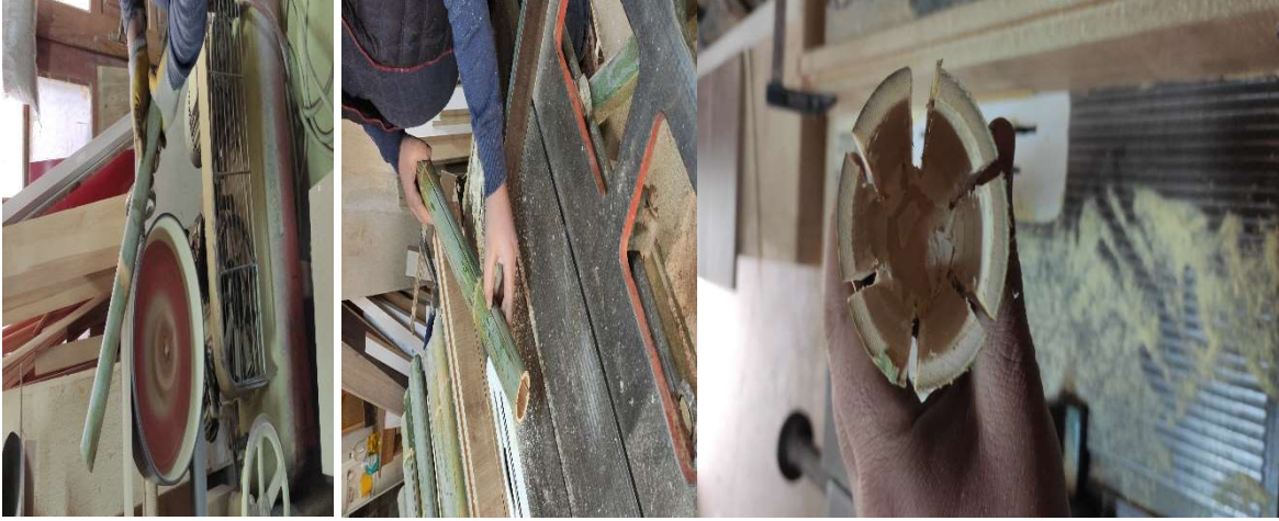
Şekil 3.4. Şeritlerin üretiminde kullanılan yatay bant zımpara makinesi ve şeritleme işlemi sonucunda bambunun görünümü.
