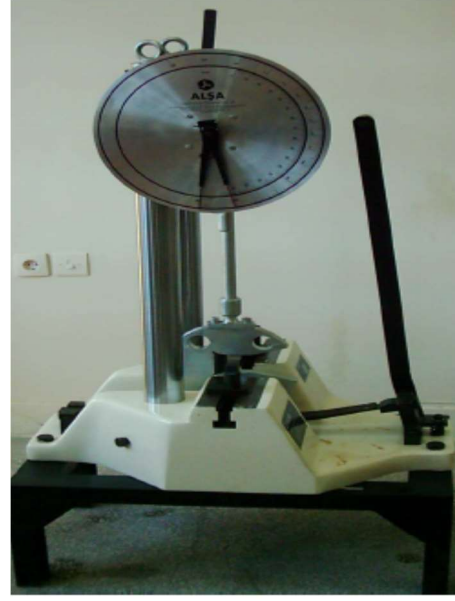
Şekil 1 Şekil 3.10. Dinamik eğilme (darbe) direnci test cihazı ve testin şematik görüntüsü (Foto Ersin,2022)
