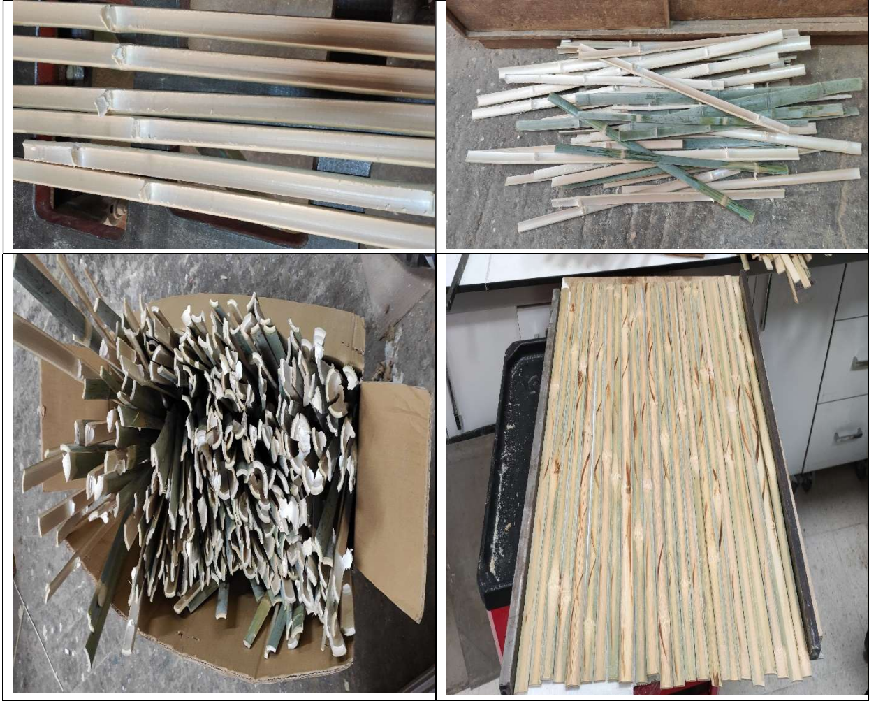
Şekil 3.5. Üretilen bambu şeritleri ve yüzey düzgünlükleri sağlanmış şekli.
