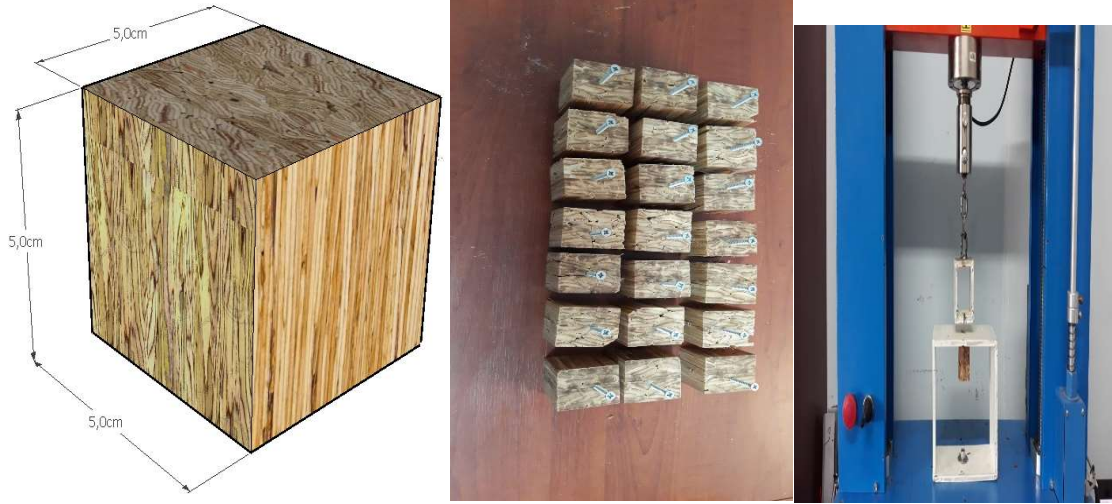
Şekil 3.11. Vida tutma kapasitesinin tespiti için kullanılan test makinesinin görüntüsü ve test örnekleri
