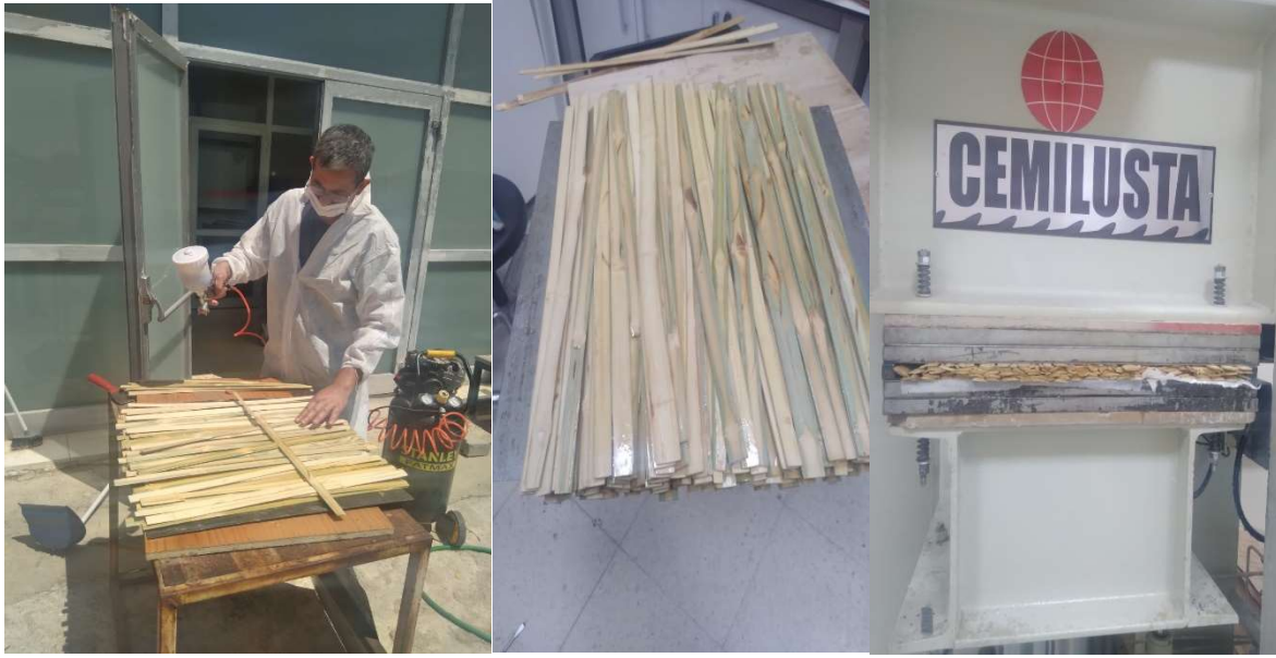
Şekil 3.6. şeritlere tutkal uygulanması, taslak haline getirilmesi ve preslenmesi
